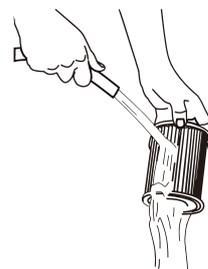
5. Nachdem Sie die Filterkartusche gereinigt haben, schmieren Sie den DICHTUNGSRING **12** großzügig mit Vaseline und setzen den Filter in umgekehrter Reihenfolge zusammen. Bevor Sie die Filterpumpe neu starten, entfernen Sie den Stopfen **4**.
