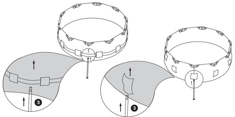
11. Schauen Sie beim Einführen des vertikalen Beins durch das Loch im T-Stück. Drehen Sie es, bis der Kopf mit dem Loch fluchtet und herauspringt. Das Bein wird dadurch im Rohrende fixiert. Wiederholen Sie dies bei den übrigen vertikalen Beinen.
