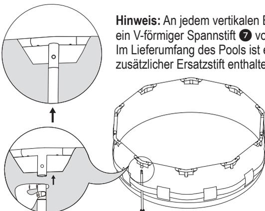
12. Prüfen Sie sorgfältig, dass sämtliche Armaturen, Ständer und Träger ordnungsgemäß montiert und gesichert sind. Prüfen Sie, ob die Abflussarmatur ordnungsgemäß angeschlossen wurde und die Kappe eingerastet ist.
