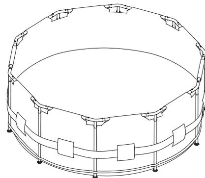
13. Füllen Sie den Pool bis zu einer Höhe von ca. 1 Zoll (2,54 cm) mit Wasser. Unterbrechen Sie das Füllen und glätten Sie alle Falten am Beckenboden, indem Sie von der Mitte aus nach außen arbeiten, so dass er sich gleichmäßig füllt.
