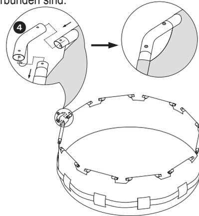
9. Schieben Sie die Stifte **6** von oben in die T-Stücke, bis sie an der Unterseite der T-Stücke einrasten.
