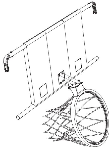
11. Installieren sie die montierte hintere Platte an den Vertikalträgern.
