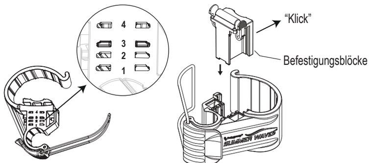
4. Setzen Sie die vertikalen Pfosten in die Rahmenklemmen ein und sichern Sie sie.
