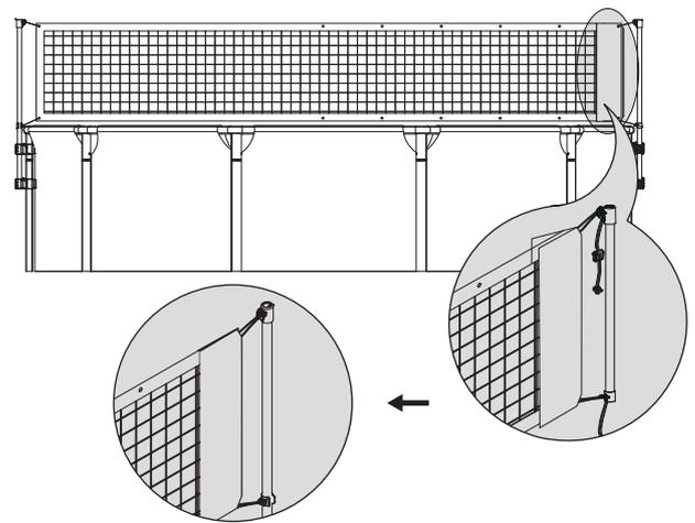
9. Befestigen Sie die Verriegelungsknöpfe der Netzbefestigungsseile, um das Netz zu spannen.
