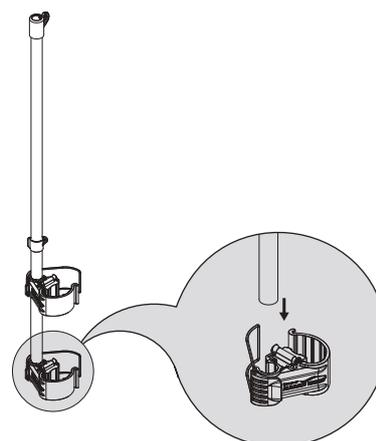
5. Installieren Sie die montierten Befestigungspfosten auf die Vertikalträger des Pools.
