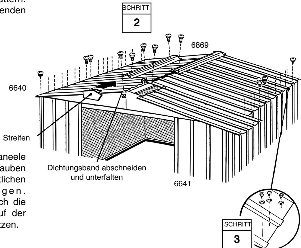
**3** Das untere Ende der Paneele mit selbstschneidenden Schrauben und U-Scheiben an den seitlichen Dachrahmen befestigen. Schrauben und Muttern durch die Dachrahmenüberlappung auf der Unterseite des Paneels benutzen.
