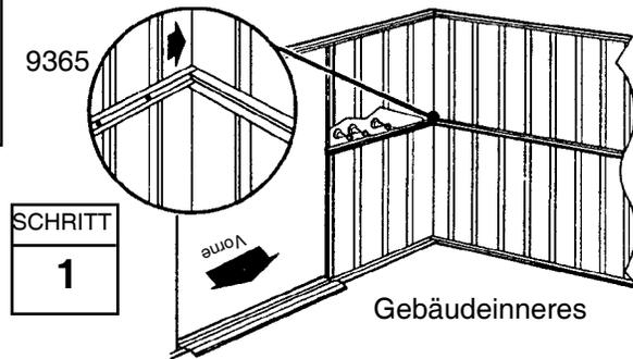
**1** Die **vorderen Wandführungen** mit Schrauben in ihren Positionen zwischen dem Ende der Seitenwandführung und dem Eckpaneel befestigen. Zu diesem Zeitpunkt noch keine Schraube in die Bohrung am Ende hinter der Türöffnung einschrauben.
