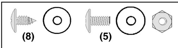
Die Dachpaneele werden am besten mit einer Stufenleiter montiert. Beginnen Sie mit der Installation der Dachpaneele auf der hinteren, rechten Seite. Alle Dachschrauben müssen mit einer U-Scheibe unterlegt werden.
