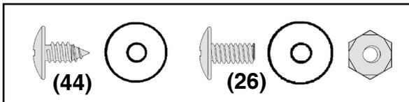
**1** Eine **Firstabdeckung** mit Schrauben und Muttern auf dem Dachteil installieren. Die Dachpaneelrippen, **Firstblende** und Firstabdeckung mit Schrauben und Muttern zusammen befestigen.
