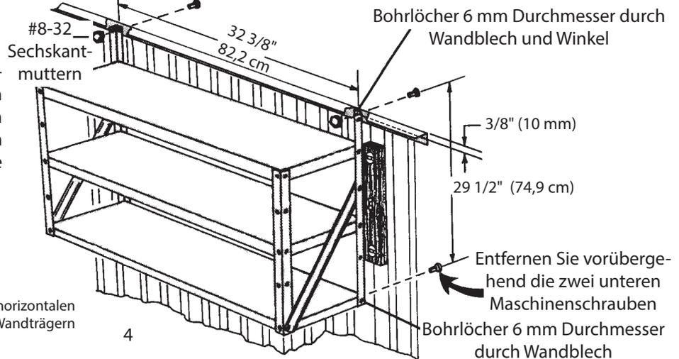
\* Gemäß dieser Beschreibung kann das Regal an Bauten mit horizontalen Wandverkleidungen angebracht werden, wenn es zwischen den Wandträgern befestigt wird.
