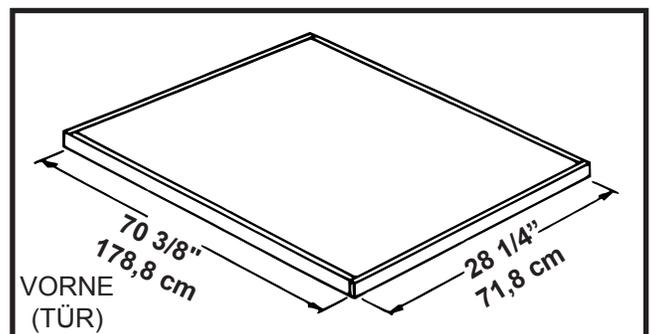
Hinweis: Abmessungen der fertigen Bodenplatte nach Entfernen der Verschalung.
