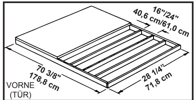
Hinweis: Die Plattform/Bodenplatte ragt auf allen vier Seiten 1,4 cm aus dem Bodenrahmen heraus. Versiegeln Sie diese 1,4 cm Holz mit einem Dachkleber (nicht im Lieferumfang enthalten) oder schrägen Sie diese 1,4 cm Beton beim Gießen für eine gute Drainage ab.
