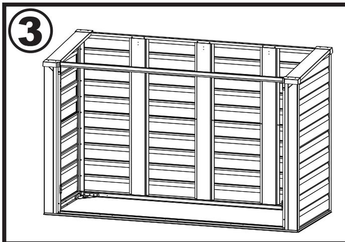
Seitliche Abschlussleiste, hintere Abschlussleiste & Sturz montieren
