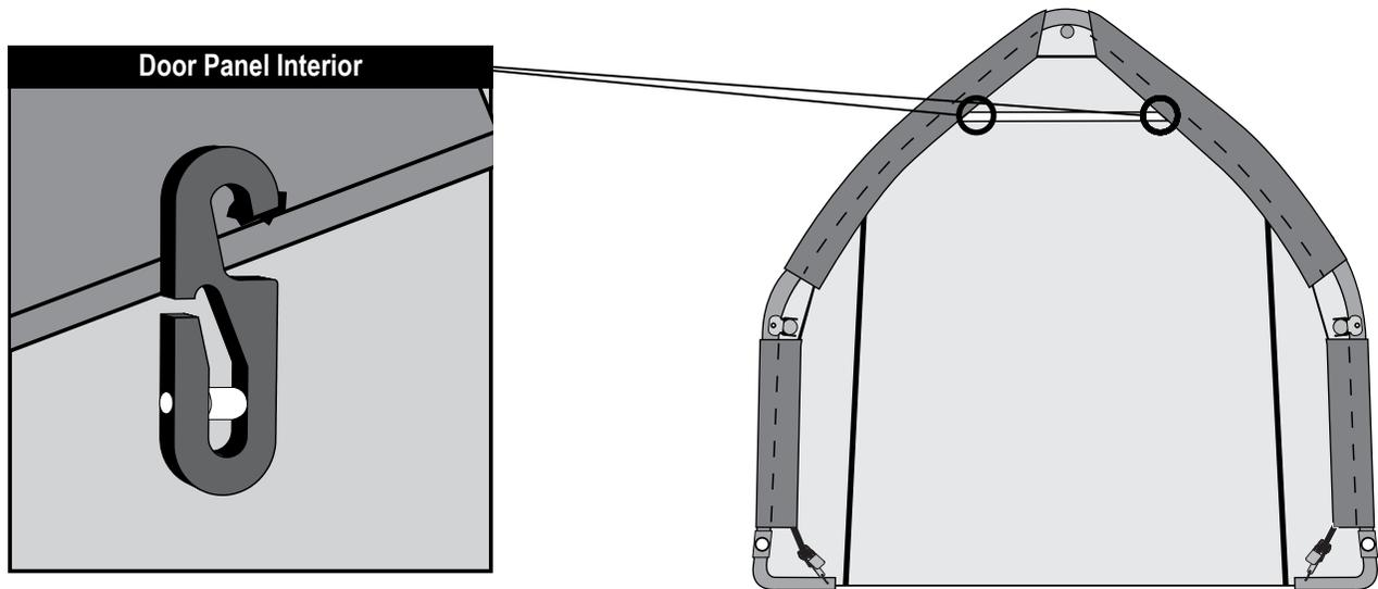
B. Führen Sie das Seil vom Knoten nach unten unter der Tür zum S-Haken. Führen Sie das Seil durch die Rolle des S-Haken. Wiederholen Sie diesen Vorgang auf der anderen Seite..
