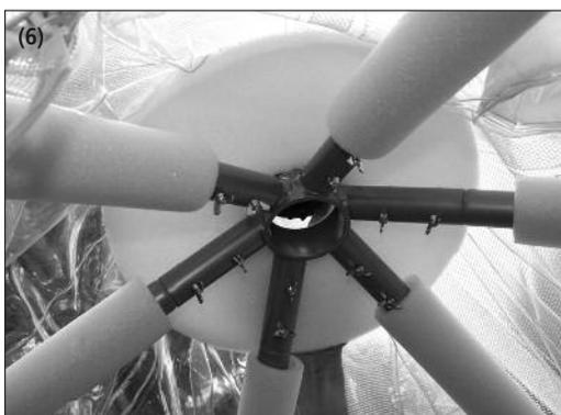
(6) Die Zentrierung erfolgt durch das Einfügen des Zentrierzapfens (schwarzer Kunststoffzapfen in der Mitte des Florino-Oberteils) in die dafür vorgesehene Öffnung des Mittelstücks im Florino-Gerüst.
