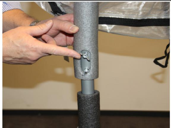
3.) Sie montieren im nächsten Schritt die diagonalen Querstangen wie in Abbildung 2. Bitte achten Sie darauf, dass die mit Isolierung ummantelte Diagonalstange außen angebracht ist.
