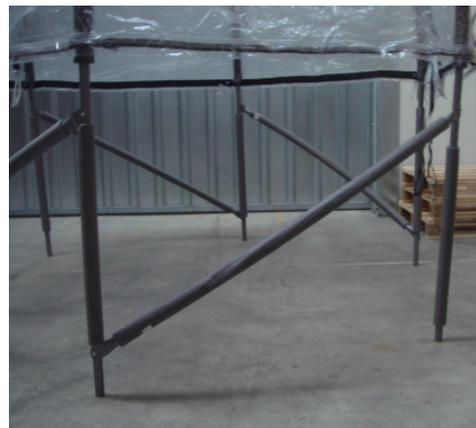
4.) Montieren Sie im Anschluss die restlichen diagonalen Querstangen (ohne Isolierung) innerhalb der bereits eingesetzten Diagonalstangen.
