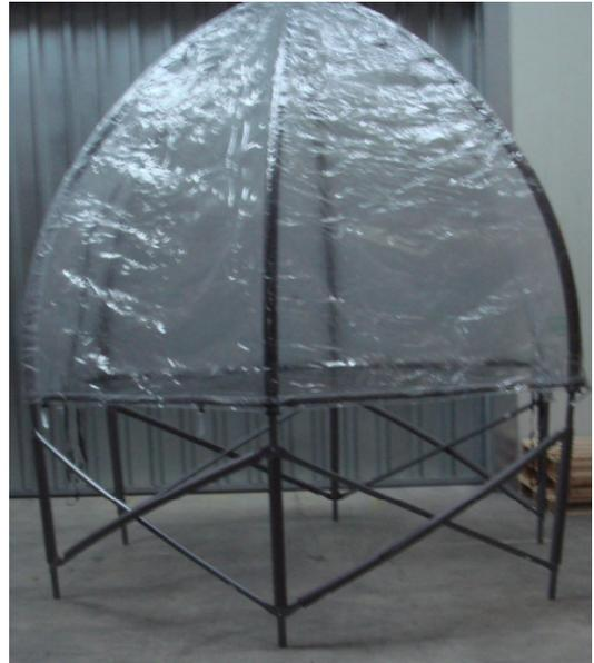
5.) Sie setzen nun die beiden Folienteile an, beginnend an den Türreißverschlüssen und schließen die Reißverschlüsse wie auf Abbildung 4.
