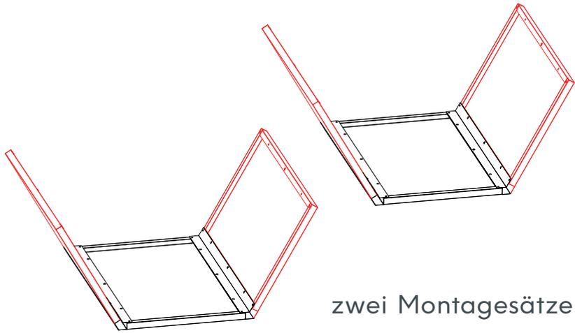
Auf dieser Seite gibt es eine zusätzliche gebogene Struktur im Vergleich zur anderen Seite. Bitte achten Sie darauf, dass die gleiche Struktur symmetrisch angeordnet wird.
