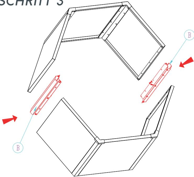
Auf dieser Seite gibt es eine zusätzliche gebogene Struktur im Vergleich zur anderen Seite. Bitte achten Sie darauf, dass die gleiche Struktur symmetrisch angeordnet wird.
