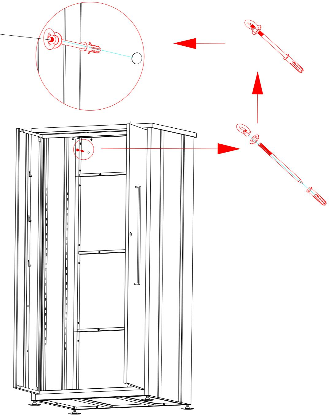
Nachdem Sie den Werkzeugschrank in die entsprechende Position gebracht haben, stellen Sie die verstellbaren Füße unten ein, bis die linke und rechte Tür in einer horizontalen Position bleiben. Verwenden Sie dann einen Bohrer mit  $\varnothing 10$  mm, um Installationslöcher in den Boden zu bohren (Bohrtiefe > 60 mm).
