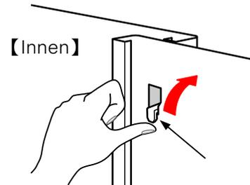
Sie können es entriegeln, indem Sie den Riegel auf der Rückseite der „LOCK“-Taste nach oben drücken.
