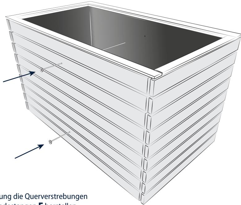
Zur Stabilisierung die Querverstrebungen mit den Gewindestangen **E** herstellen.
