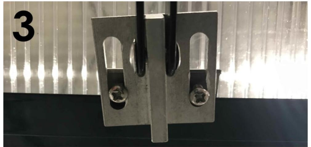
Die Halterung (2A) wird am zu öffnenden Teil des Fensters befestigt. Schieben Sie die Fensterleiste von unten zwischen Klemme (3) und Halterung (2A). Ziehen Sie die Schrauben (4) an und spannen Sie die Leiste ein.
